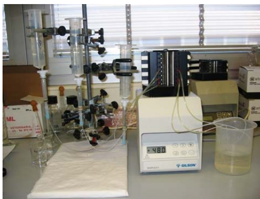
Figura 4.22. Transferència de la mostra pel cartutx amb ajuda de la bomba peristàltica.
