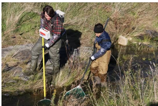
Figura 24: Pesca elèctrica amb l'aparell portàtil amb bateria Hans Grassl IG200/2.
