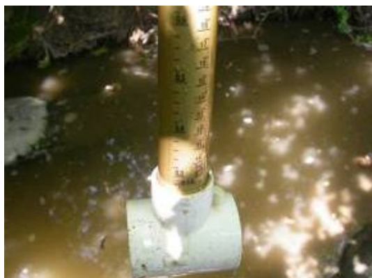
Figura 18: Correntímetre de molinet –model FP101 de Global Water- emprat per mesurar la velocitat de l'aigua
