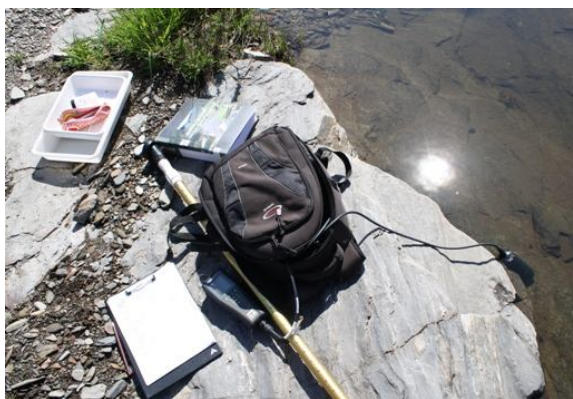
Figura 17: Presa de dades fisicoquímiques mitjançant la sonda multi paramètrica portàtil YSI Professional Plus
